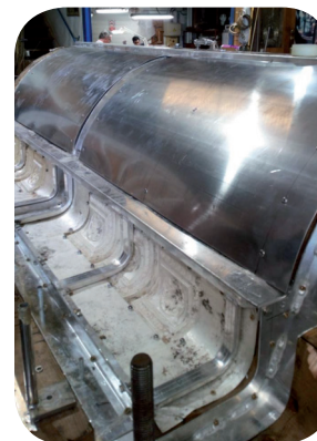
Techo de la carreta reforzado con chapa interior.
